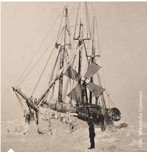
Fram i isen med vindmøllen. Fridtjof Nansen skrev om vindmøllen i sin dagbog i oktober 1893: "Den arbejder udemærket. Vi har haft dejlig elektrisk lys i dag, selvom vinden ikke har været så stærk, bare 5,8 meter i sekundet".
